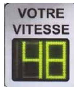
Ces appareils enregistrent en permanence le passage des véhicules, dans un but pédagogique et non répressif : prendre conscience de sa vitesse réelle permet en effet d'adapter sa conduite et d'assurer ainsi la sécurité de tous les usagers de la route.
