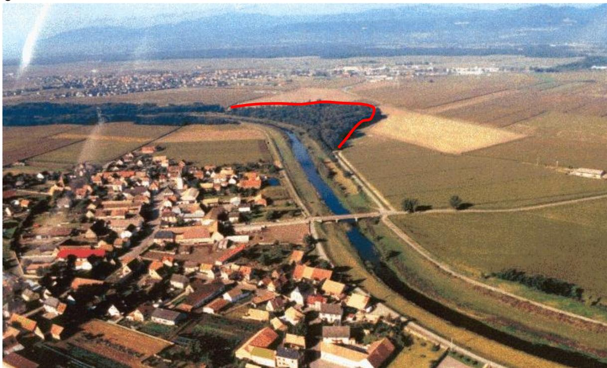
Lors de la réfection de la digue après les inondations de 1983, la digue a été reconstruite à l'extérieur du bois sur le tracé d'un ancien méandre; la rivière peut ainsi retrouver un peu de mobilité lors des crues.
